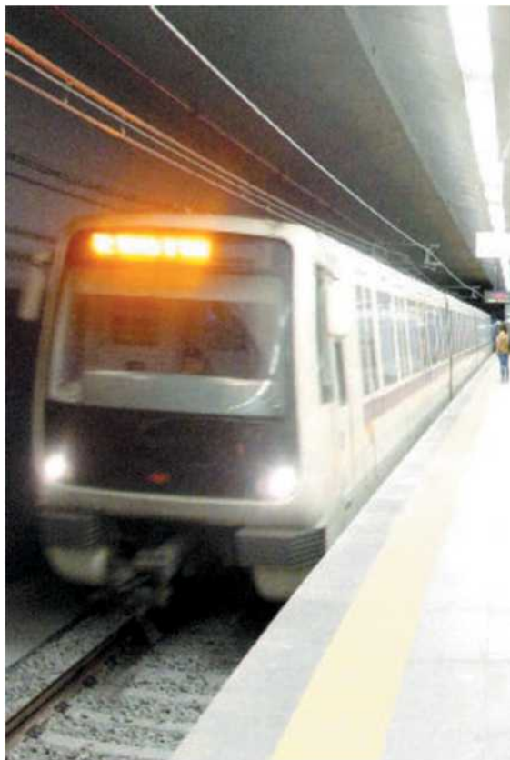
Gallerie La sabbia viene rilasciata ogni volta che il treno frena
